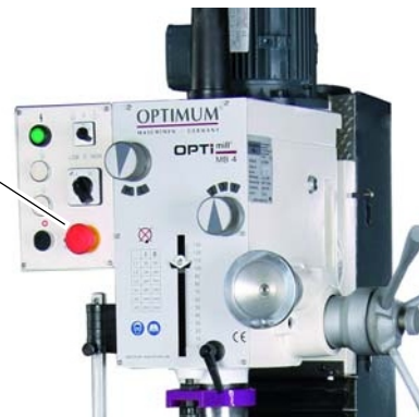
Img. 1-1: Pulsador de PARADA DE EMERGENCIA
